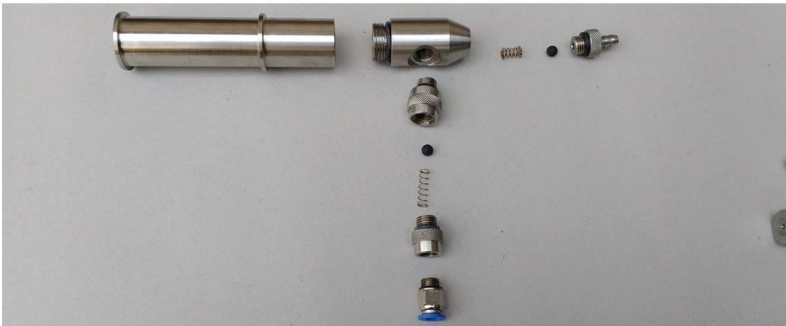
A seringa dosadora poderá ser montada nas dosagens de 10, 15 ou 21ml e deverá ser lavada e esterilizada em água fervente de 10 a 15 minutos após a vacinação. Na troca do embolo por uma dosagem maior é necessário um ajuste na velocidade da vacinadora.
